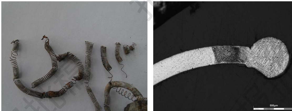
(c) 电加热丝电热熔痕的宏观形貌 (d) 电加热丝电热熔痕的金相组织
