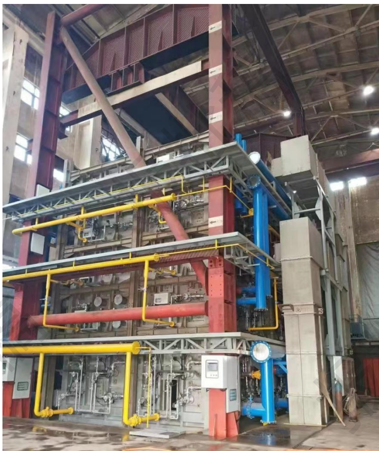
图 1 建筑结构体系耐火性能试验装置外观照片
