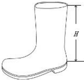
图 1 灭火防护靴靴帮高度测量示意图
